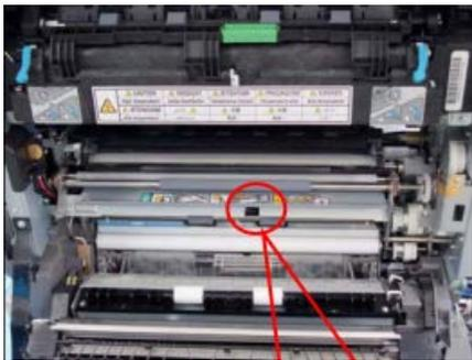
3、检查对位辊前的导纸片是否变形
