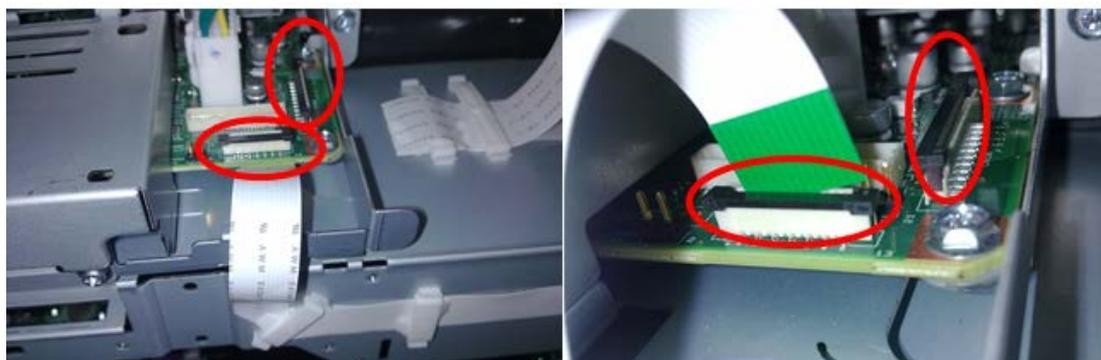
2、激光单元安装不到位，重新正确安装
