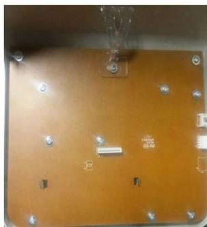
2、更换主板（更换新主板时，请将原主板上的八角芯片取下安装到新主板上，请注意 针脚
