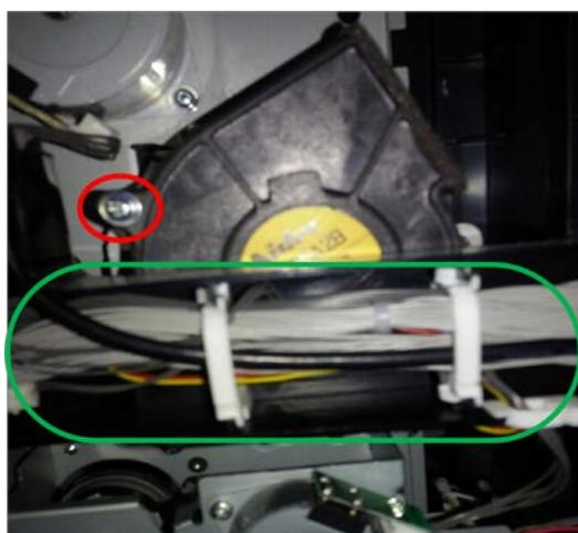
2、更换驱动板（前提做引擎数据备份‘效用-停止-0-0-停止-0-1 输入：92729272 进入维修模式-停止-0-返回-Engine Data Backup-Data Save Mode-Start-OK’，更换驱动板后出现4802 故障做引擎数据恢复‘步骤一样’，做故障复位）
