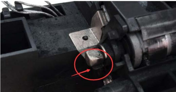
2、转印辊机器端弹簧片变形接触不良，也可能造成图像发淡，特别对于 219 系列，常见侧门松造成的单边发淡，可尝试在侧门卡扣处缠黑胶布以使侧门关紧。
