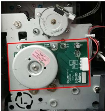
2、更换驱动板（做引擎数据备份‘效用-停止-0-0-停止-0-1 输入：92729272 进入维修模式-停止-0-返回-Engine Data Backup-Data Save Mode-Start-OK’，更换驱动板后出现4802 故障做引擎数据恢复‘步骤一样’，做故障复位）
