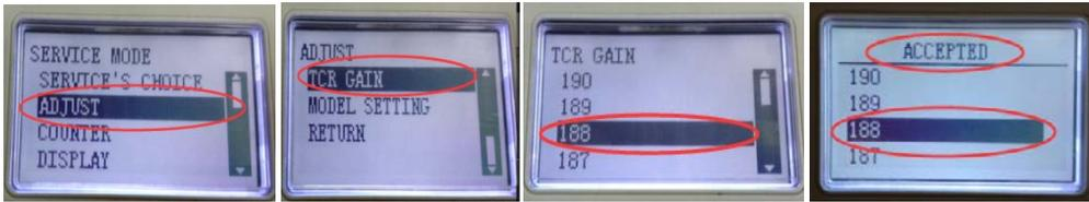
3. 关闭电源并耐心等待 10 秒，重新开启复印机。若仍跳代码，按以上步骤继续调高 TCR GAIN 的数值，直至复印机正常开启。放入适量纸张（建议使用再生纸），取出碳粉瓶，打开稿台盖板，连续复印10张全黑件。
